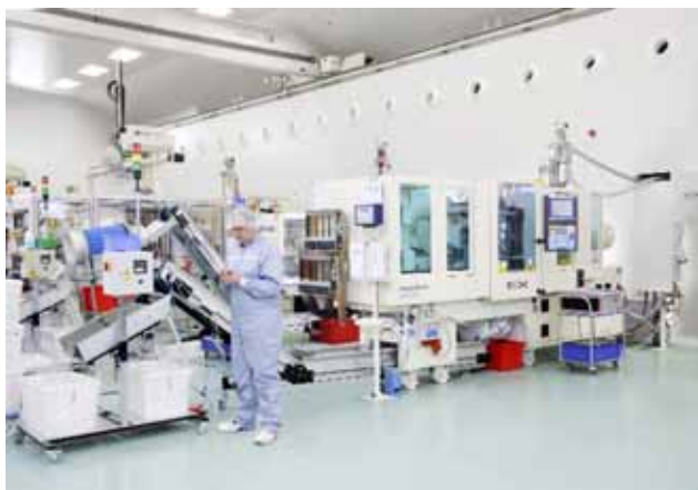
Fabricación en sala limpia en la planta de Rexam en Neuenburg: máquinas de moldeo por inyección totalmente eléctricas, de bajas emisiones y precisas, por lo que son especialmente idóneas para la producción en sala limpia - Foto: Krauss Maffei
