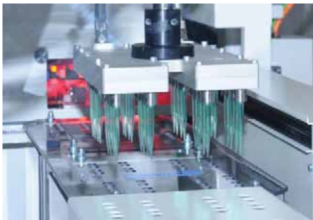
Esta garra de extracción llega al útil de moldeo por inyección, toma las pipetas del útil de 32 cavidades, realiza un control de presencia y sale de nuevo en 0,25 segundos - Foto: Hekuma
