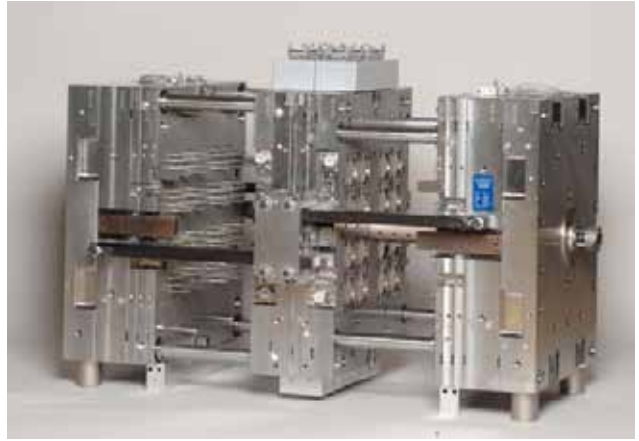
Con un gran número de cavidades y bien diseñado hasta el último detalle: útil de moldeo por inyección de 128+128 para la fabricación de protectores de jeringuillas - Fotos: Schöttli
