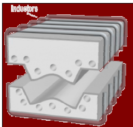
a.- Molde frío, abierto en posición inicial
