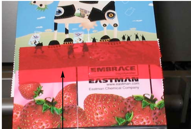
Unión (empalme) solapada
