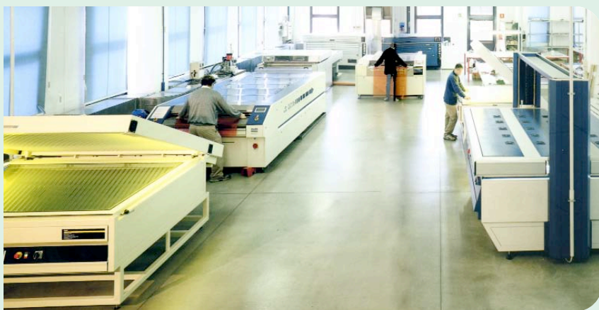
Para la producción de placas de polímero sólido esta firma posee tres líneas para formatos grandes (127x203 cm). En su departamento de producción cada fase del trabajo es cuidadosamente controlada desde la exposición al lavado, y desde el secado al acabado final
