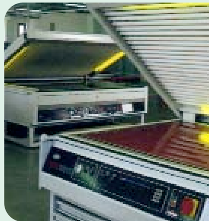
Unidad de exposición para placas de polímero sólido analógicas y digitales
