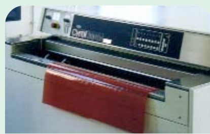
El lavado de la placa sólida elimina el polímero no impreso
